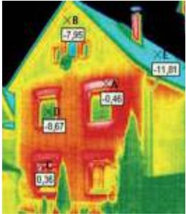
Durch die Gebäudethermografie können Fehler in der Bauausführung eindeutig nachgewiesen werden. Anhand der Oberflächen-temperaturverteilung kann die Wärmedämmung von Gebäuden überprüft werden. Thermografien können bei 5°C und kälter durchgeführt werden.
